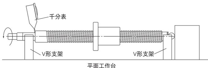
● 法兰安装面相对于丝杠轴轴线的圆跳动(参照 B15-24上的 表7)
