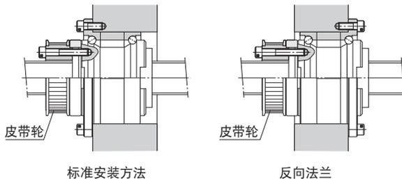
注) 法兰反向时, 请在公称型号中标明K。(只适用于BLR型)
