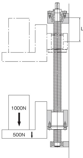
垂直搬运时进给丝杠系统的轴向刚性造成的定位误差[使用条件]
