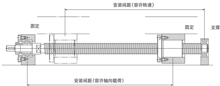
图9 丝杠轴安装方式：固定-支撑
