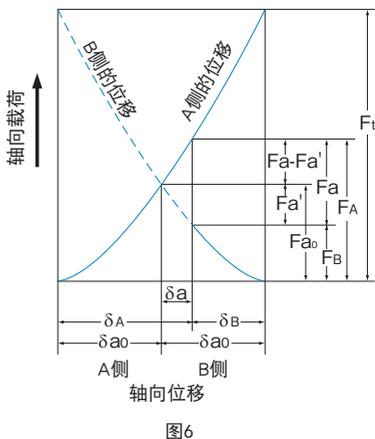
通过改变螺母中央沟槽的螺距,在A、B侧形成相位差,从而施加预压载荷( $F_{a0}$ )。在预压载荷作用下,A、B侧各自产生 $\delta_{a0}$ 的弹性变位。在此状态下,如果有外部轴向载荷( $F_a$ )作用,那么A、B侧的变位量将如下所示。
