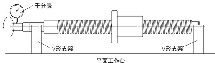
● 螺纹沟槽面对丝杠轴支撑部轴线的半径方向圆周跳动(参照 A15-15上的 表5)
