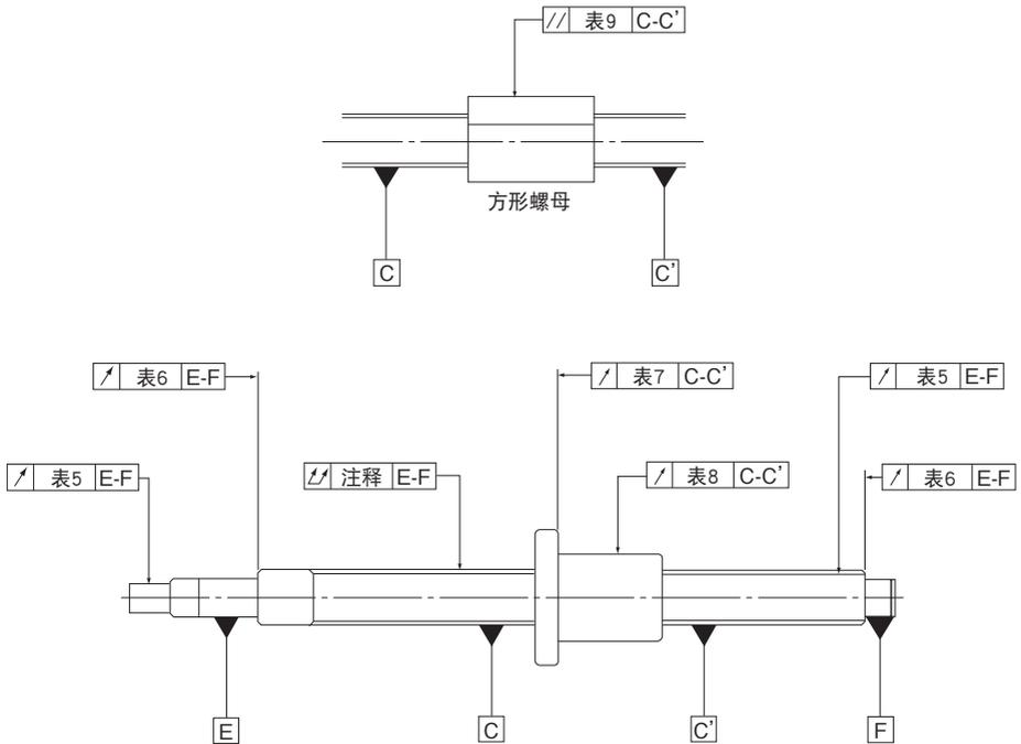
注)丝杠部外径相对于丝杠轴支撑部轴线的半径方向全跳动公差请参照 JIS B 1192(ISO 3408)。
