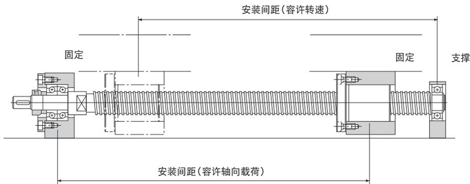
图2 丝杠轴安装方式：固定-支撑
