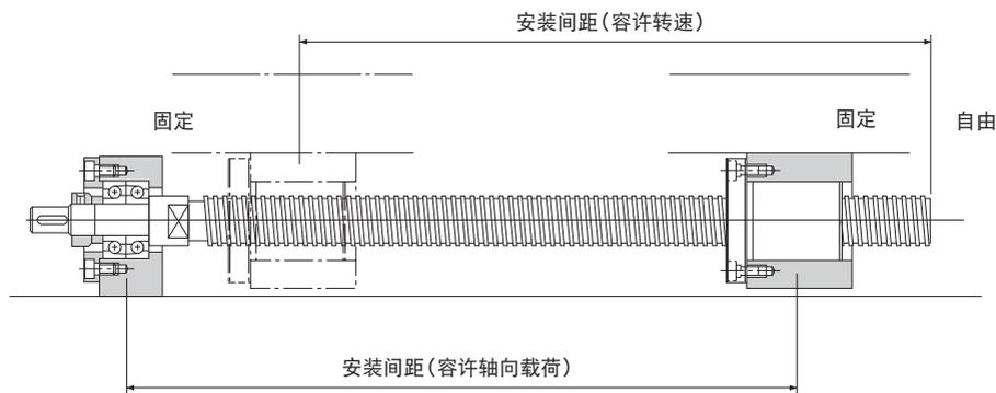
图8 丝杠轴安装方式：固定-自由
