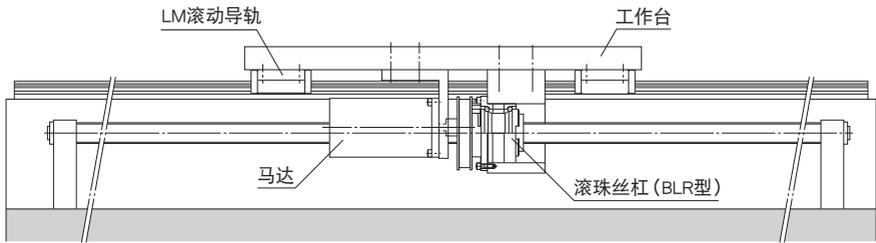
图3 往工作台上的装配例(丝杠轴固定)
