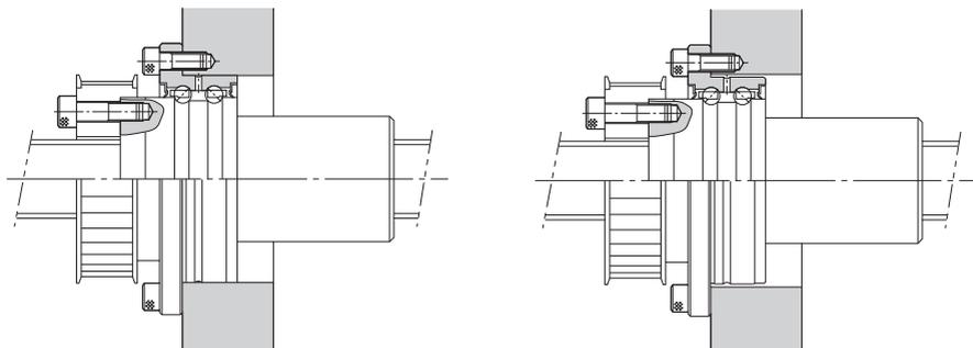
装配到支承座的作业可以在外圈法兰端面上进行。
