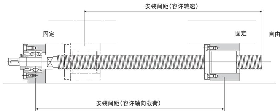
图1 丝杠轴安装方式：固定-自由
