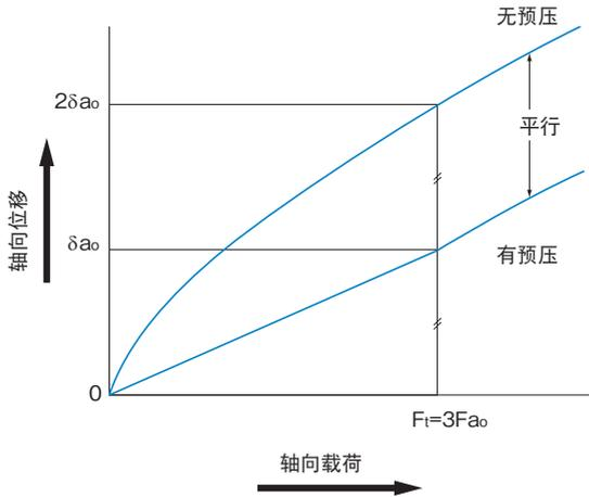
图4 滚珠丝杠的弹性变形曲线
