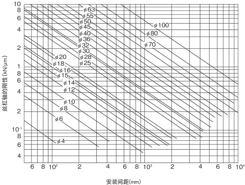
图8 丝杠轴的轴向刚性(固定-固定)
