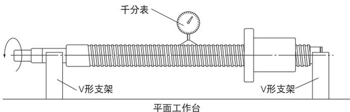
注) 丝杠部外径相对于丝杠轴支撑部轴线的半径方向全跳动公差请参照 JIS B 1192 (ISO 3408)。
