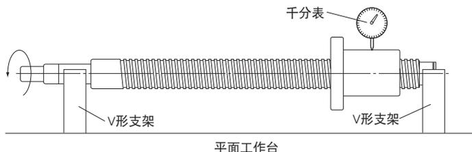
● 支撑部端面相对于丝杠轴支撑部轴线的圆跳动(参照 A15-16上的 表6)
