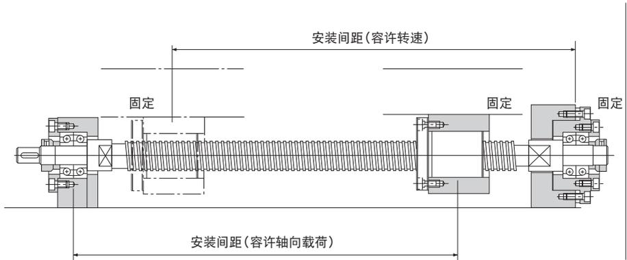
图10 丝杠轴安装方式：固定-固定
