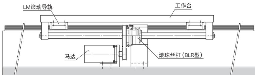
图2 往工作台上的装配例(螺母固定)
