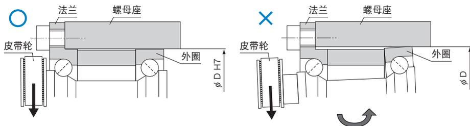
注) 由于是外圈分割型产品, 所以为了使非法兰侧的外圈不会滑动, 需要设定螺母座的内径公差。(推荐H7)
