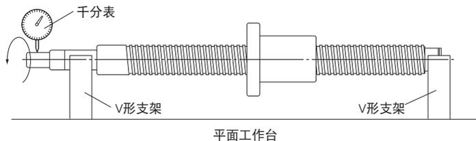
● 螺纹沟槽面对丝杠轴支撑部轴线的半径方向圆周跳动(参照 B15-23上的 表5)
