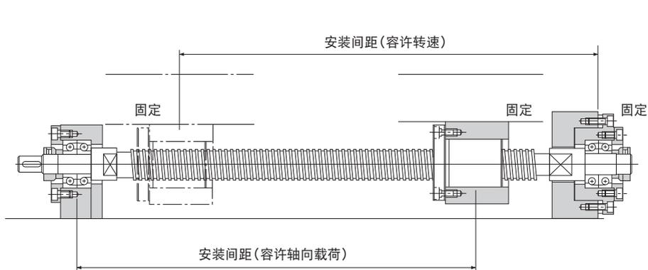
图3 丝杠轴安装方式：固定-固定
