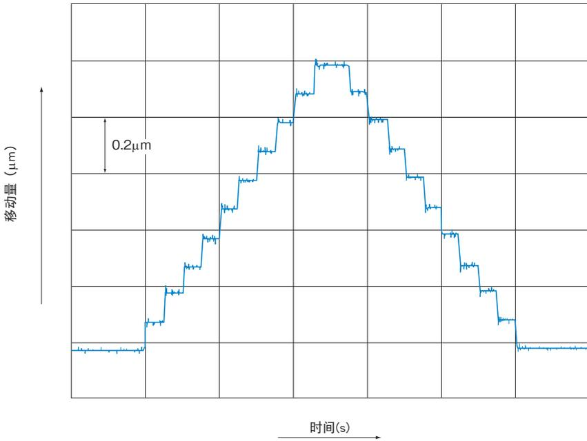
图4 进给 $0.1\mu\text{m}$ 时的移动量数据
