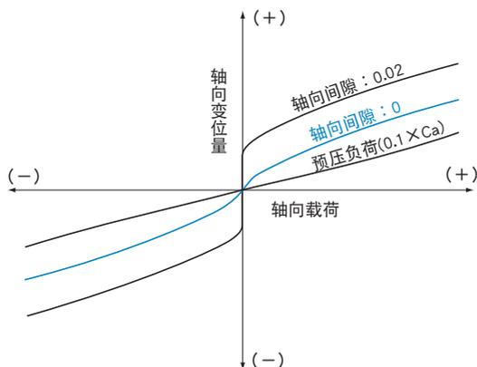
图6 由于轴向载荷引起的轴向变位量
