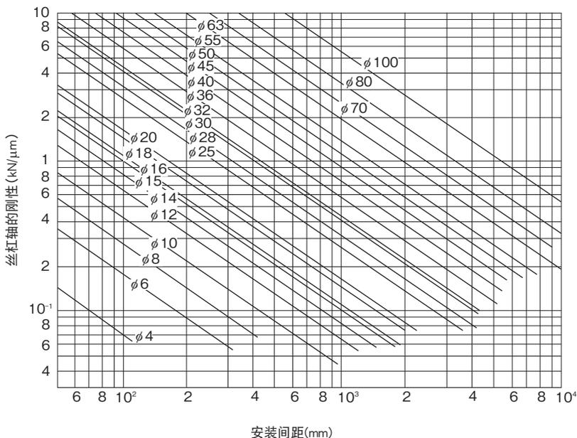
图15 丝杠轴的轴向刚性(固定-固定)
